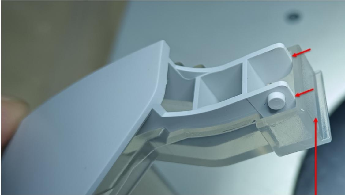
1. 治具后段与产品干涉, 导致喷漆烘烤后产品变形
