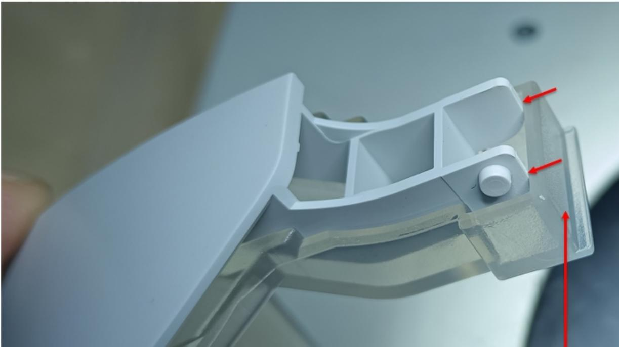
1. 治具后段与产品干涉, 导致喷漆烘烤后产品变形
