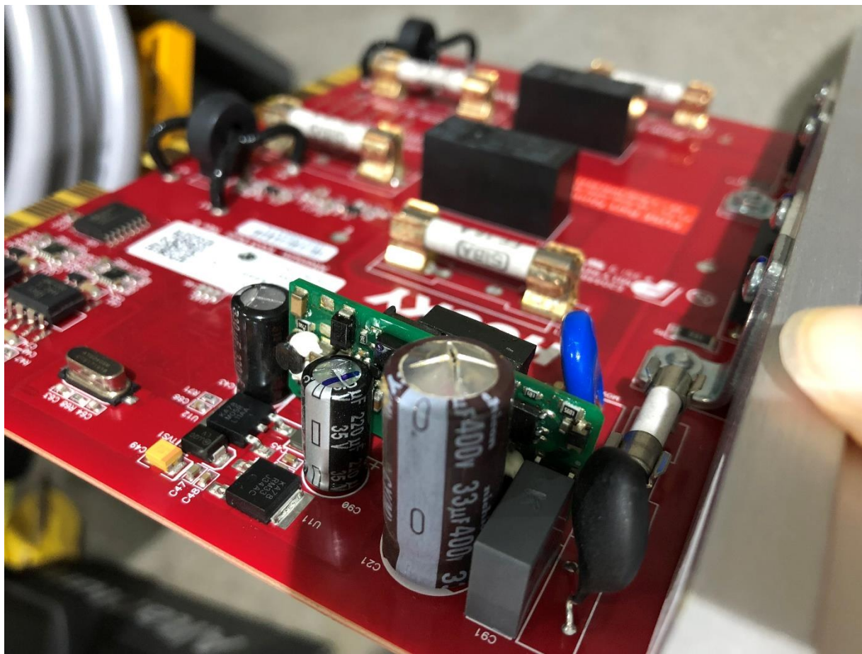
鼓包且裂开 需更换
